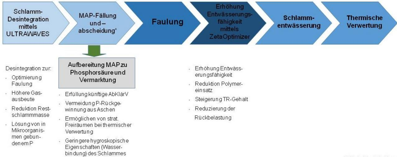
Abbildung 3: Modulares Verfahren zur P-Freisetzung aus dem ÜSS (Ultrawaves-Desintegration), P-Fällung und –Abscheidung sowie zur Optimierung der Schlammentwässerung
