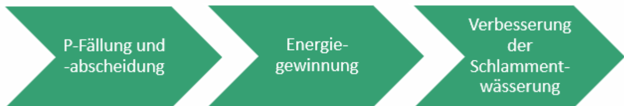
Abbildung 9: Modulares Verfahren zur P-Rückgewinnung aus eingedicktem Überschussschlamm, Steigerung der Gasproduktion in der Faulung in Kombination mit dem Abbau von Schlammmasse sowie Optimierung der Schlammentwässerung.
